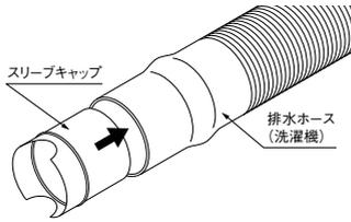
①洗濯機の排水ホースを接続する際に、排水ホースに付属のスリーブキャップを挿入してください。〈挿入していないと、排水ホースの剛性が弱くなり、ホース差込口からの水漏れの原因となります。〉
