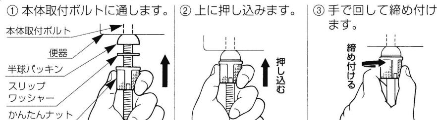
※ 便座が便器の取付穴にうまく入らない場合は、本体取付ボルトを抜いてから回転させ、取付穴の間隔と合うように調節してください。
