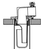
③本体よりスライドカバーとホースジョイントを取り外し、排水管と本体に接着剤を塗布し、本体を排水管に差し込んでください。(VU管に接着する場合にはVUプッシュを本体に接着してからプッシュ外周部に接着剤を塗布し、本体を排水管に差し込んでください。)
