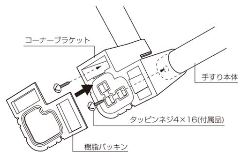
手ずり本体のネジ穴と差し込みコーナーブラケットの裏側の穴をあわせタッピンネジ(付属品)をネジ込み固定します。
