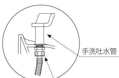
※漏水を起さないために、確実に締めてください。
