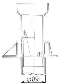
②排水ソケットを平座金と便器固定用木ねじ、平座金と排水ソケット取付ねじで床に固定します。
