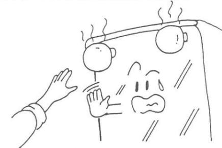
照明(白熱球)必ず同じワット数、直径(40W、95mm)のものと交換してください。
