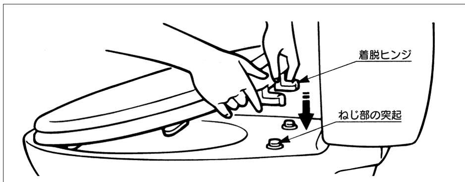
3. 左右の着脱ヒンジのハンドルを内側「つける側」に回して、着脱ヒンジを固定します。
