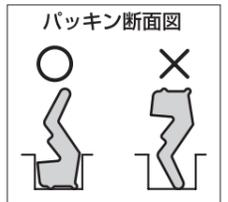
1. 排水管の種類によって使用するリングが異なります。下図のとおり選定してください。
