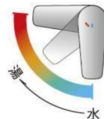
節湯水栓 よく使うレバー正面で操作しても、水しか出ないので、ムダな給湯器の作動がありません。
